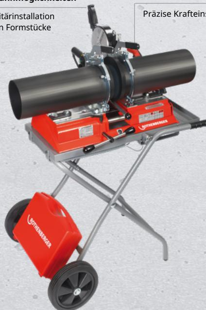
Set beinhaltet: Grundmaschine mit elektrischer Fräseinrichtung, elektronisch regelbarem Heizelement, herausnehmbar. Grundspannbackensatz rechts und links Ø 160 mm (No. 54082), Rohrauflagen Ø 160 mm, Reduktionsspann- und Auflagensätze für Ø 40, 50, 56, 63, 75, 90, 110 und 125 mm im Koffer (No. 1000002970), Montagewerkzeug, fahrbares Arbeits- und Transportgestell (No. 1000002971) Fräsermesser (No. 55685)
